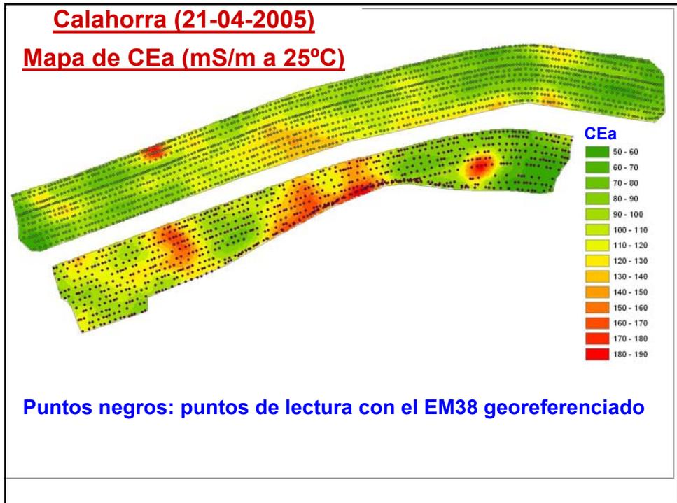
**Mapas de salinidad del suelo ( $EC_e$  del extracto saturado) en base a lecturas del sensor ( $CE_a$ ) y calibraciones  $CE_a-CE_e$**
