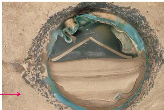
**“Trocós” causados por sufosión (piping): erosión por flujo subsuperficial o túnel**
