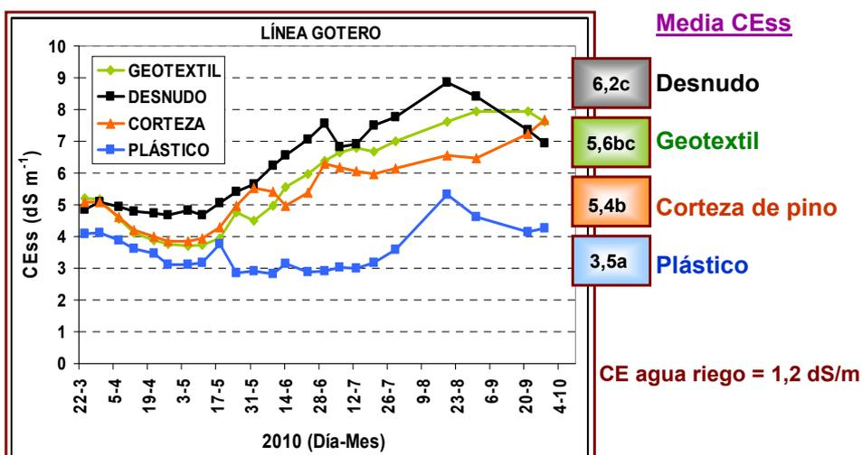
**Evolución de la CE de la solución del suelo (CEss) extraída con sondas de succión (media de los valores a 20 y 40 cm de profundidad) en la línea de goteros para los diferentes tratamientos de acolchado.**
